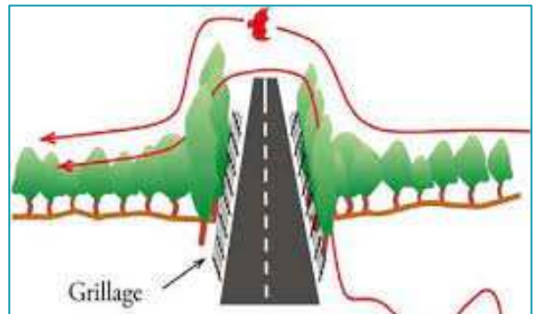
Figure 47 : schéma du dispositif « hop-over »
